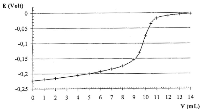
4. Déterminer le volume équivalent  $V_e$ . En déduire la concentration en ions chlorure de la solution S.
