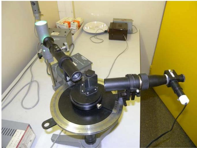
Placer une lampe à vapeur de mercure, rechercher la bonne position de la lunette afin d'observer le spectre puis diminuer la largeur de la fente.
