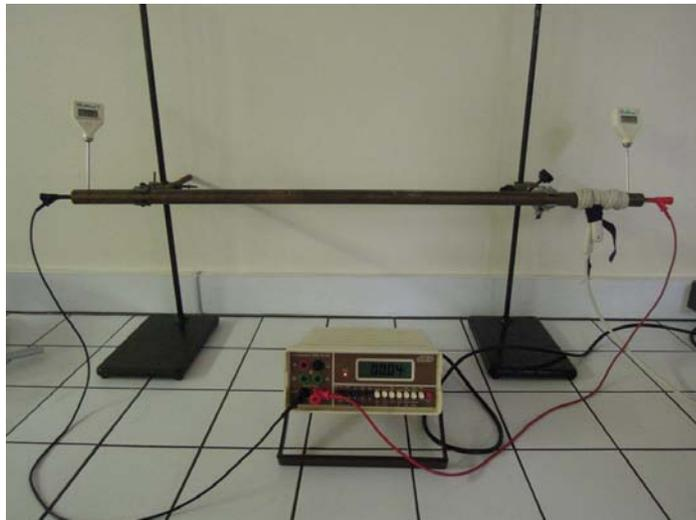
On mesure la tension entre les extrémités de la barre.
