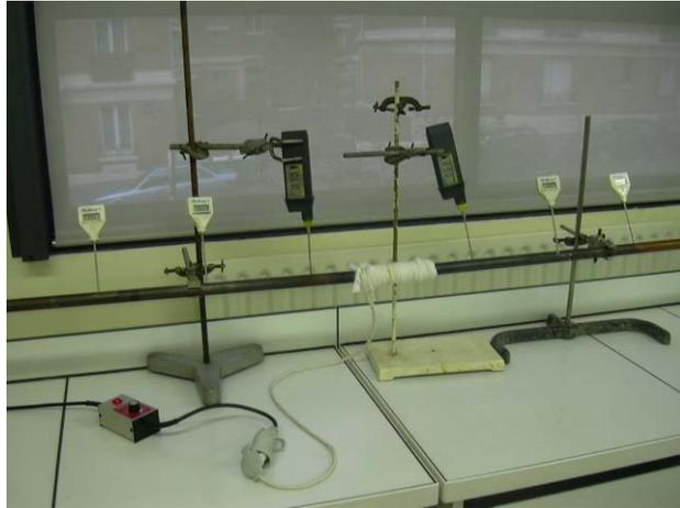
On place les thermomètres dans les trous des barres de rayon  $r$  et suffisamment longues, l'une étant en acier, l'autre en cuivre ou en laiton.
