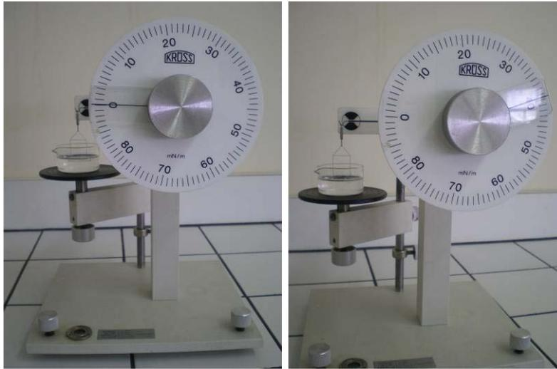
On met le porte godet en position haute. En descendant le porte godet, l'anneau tend à sortir de l'eau. En tournant la vis de l'aiguille, maintenir la flèche horizontale. La valeur de la tension superficielle est celle lue au moment de la rupture. On peut recommencer 2 fois l'expérience afin de confirmer le résultat.
