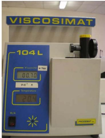
On remplit un tube à essai jusqu'à 1 cm du bord d'un liquide. On place le tube à essai dans le trou ad hoc. On tape d'un coup sec le disque. Une bille tombe dans le liquide. Son temps de chute est proportionnel à sa viscosité. La lecture est directe.
