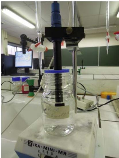
On place l'électrode de conductimétrie dans la bouteille contenant du KCl 0,1 mol.L<sup>-1</sup>
